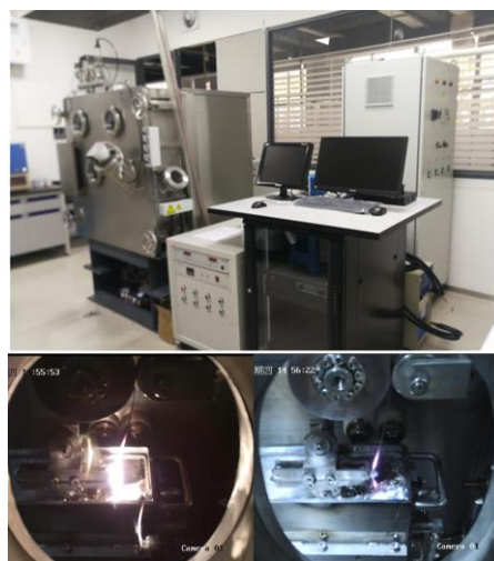
图 1 第二代感应辅助加热的 Nb 3 Al 快热急冷热处理设备。
